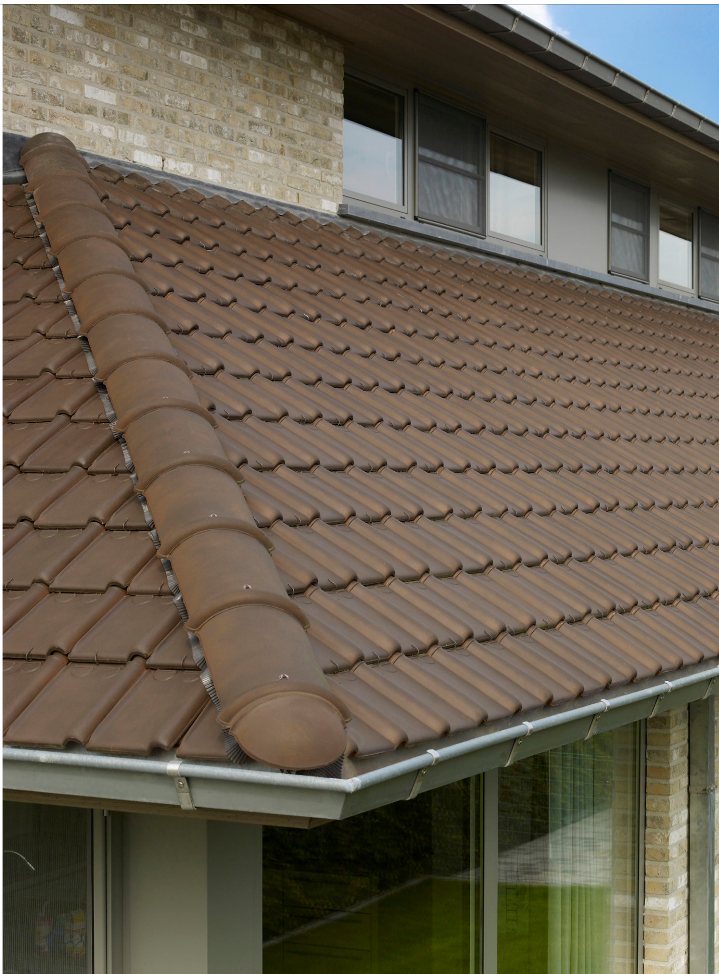
Tuile Tempête 44 Vieux cuivre: Alu-Rol Extreme sous des faitières demi-rondes à emboîtement et fixation avec des vis Torx en inox avec anneau EPDM
