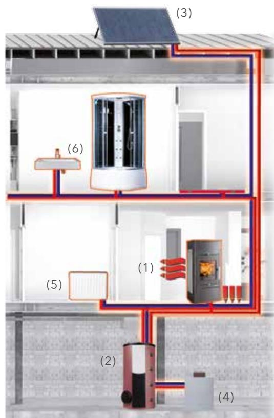
Une partie de la chaleur est utilisée pour le chauffage direct de la pièce (1). Le reste est envoyé vers un ballon tampon (2) qui peut être également alimenté par d'autres sources d'énergie telles que le système solaire (3) ou une chaudière (4). Selon les besoins, on utilise la chaleur à partir du tampon pour l'alimentation du circuit de chauffage (5) ou pour assurer la production d'eau sanitaire (6).
