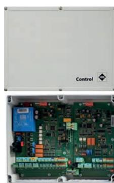
Le EM8+4 est la combinaison des modules EM8 et EM4. Il est équipé de 12 entrées de sonde et de possibilités de raccordement pour trois mélangeurs (ou soupapes d'inversion) et cinq pompes de circulation. Il est ainsi possible de raccorder jusqu'à 3 circuits de chauffage à régulation climatique et 2 ballon d'eau chaude sanitaire. Ce module est livré comme module d'extension externe, prémonté dans un boîtier mural.
