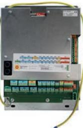
Le module EM8 chaudière est équipé de 8 entrées de sonde et de possibilités de raccordement pour deux mélangeurs (ou soupapes d'inversion) et trois pompes de circulation. Il est ainsi possible de raccorder jusqu'à 2 circuits de chauffage à régulation climatique et 1 ballon d'eau chaude sanitaire. Ce module est conçu pour être monté directement dans la chaudière HDG K10-26 V2.
