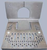
Grâce à la **grille basculante** massive automatique en fonte grise alimentée directement et grâce à la chambre de combustion brûlante éprouvée, une puissance régulière est garantie. Les éléments de la chambre de combustion peuvent être extraits individuellement et sont cuits d'usine. Les résidus de combustion sont vidés de façon fiable dans la zone des cendres inférieure à travers la grille.
