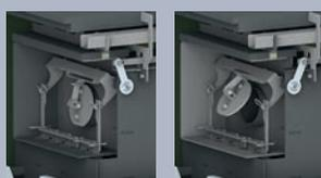
Volet de gaz de combustion fermé
