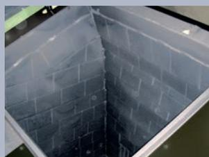
La HDG Euro est disponible en option avec un revêtement spécial résistant au feu et soudé dans l'espace de chargement pour le chauffage continu avec des plaquettes, des briquettes de bois et des déchets de menuiserie conformément aux catégories de combustibles 6 et 7 (selon la première ordonnance
