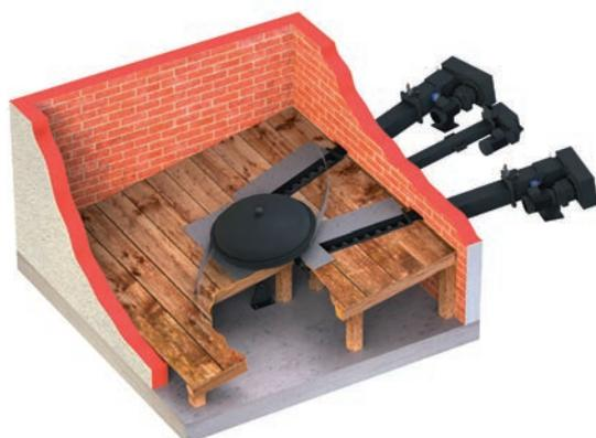
Exemple de montage de système d'extraction par désileur à double ressorts HDG FRA-D 4,5 avec deux HDG Compact 80
