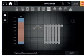
Le calcul de la température de départ du circuit de chauffage est basé sur la pente de la caractéristique de chauffage et sur la température extérieure. La correction de caractéristique de chauffage (décalage parallèle) et la consigne de température ambiante de jour/nuit sont également pris en compte.
