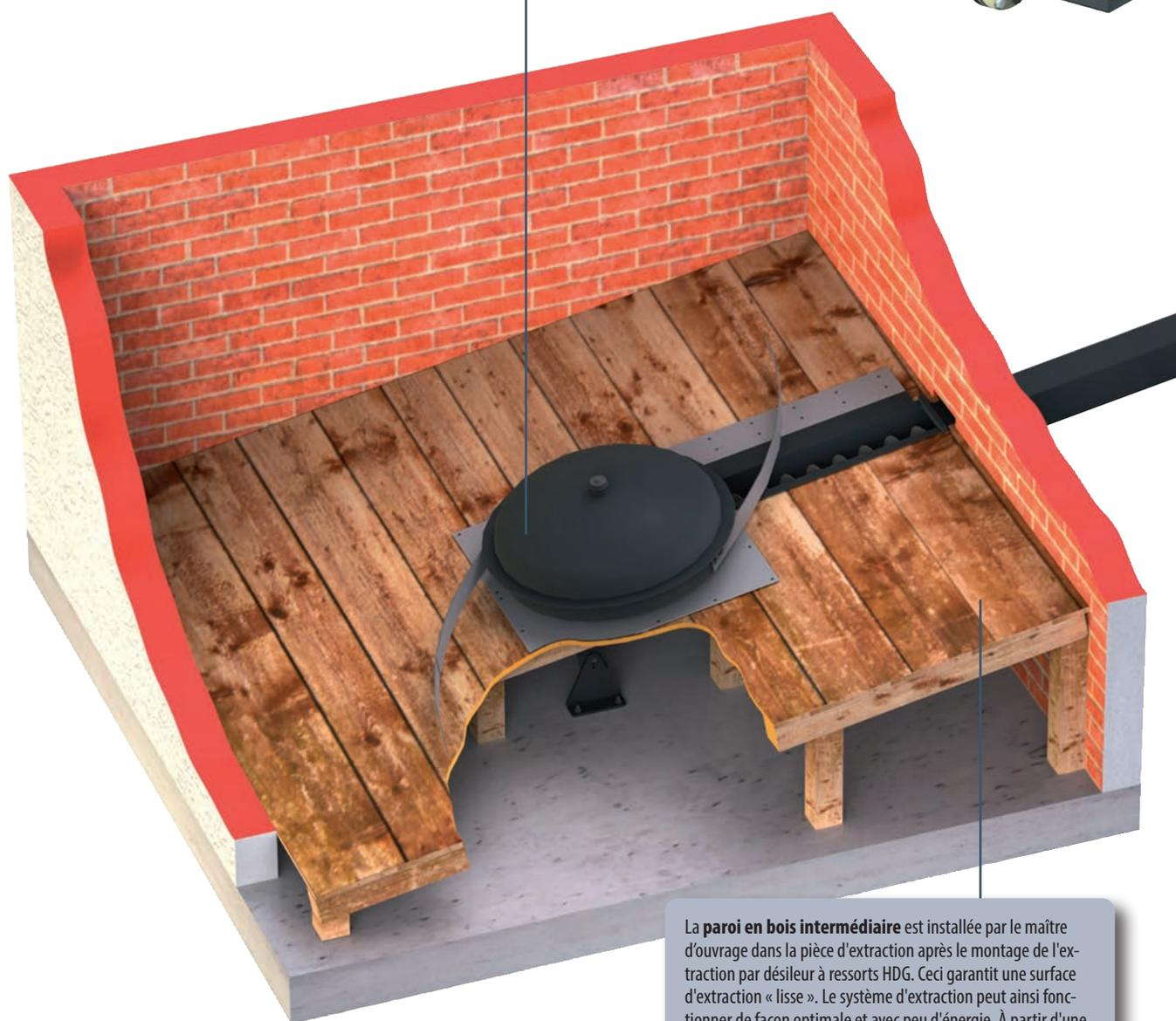
La **paroi en bois intermédiaire** est installée par le maître d'ouvrage dans la pièce d'extraction après le montage de l'extraction par désileur à ressorts HDG. Ceci garantit une surface d'extraction « lisse ». Le système d'extraction peut ainsi fonctionner de façon optimale et avec peu d'énergie. À partir d'une tôle de dosage réglable, le canal de vis ouvert peut être réglé de façon optimale pour une multitude de combustibles.
