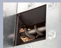
En fonction des besoins, les granulés sont amenés dans la cavité du brûleur à l'aide d'une **vis de dosage** cadencée et ensuite d'un dispositif de déchargement incliné. La surveillance de température montée avec réservoir d'eau intégré garantit cependant un maximum de sécurité de fonctionnement.
