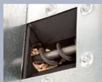
En fonction des besoins, les granulés sont amenés dans la cavité du brûleur à l'aide d'une **vis de dosage** cadencée et ensuite d'un dispositif de déchargement incliné. L'écluse cellulaire intégrée garantit un maximum de sécurité de fonctionnement.
