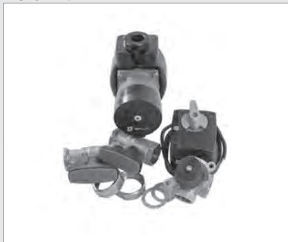
Renforceur de débit de retour DN32, avec pompe à haut rendement PLUS 32-60 (longueur totale 180 mm) avec vanne de mélange à trois voies intégrée avec servomoteur pour l'augmentation de la température de retour.
