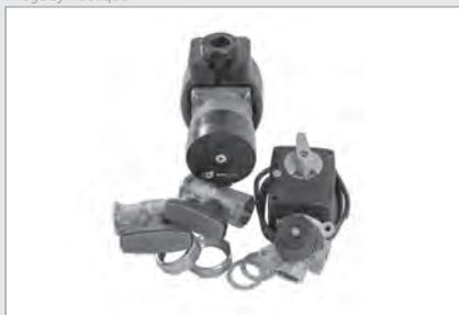
Augmentation de la température de retour DN32, avec pompe à haut rendement PLUS 32-60, longueur 180 mm, vanne mélangeuse à trois voies intégrée avec servomoteur pour l'augmentation de la température de retour.
