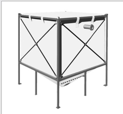
Système de stockage de pellets\* composé d'un support divisible, d'une trémie de prélèvement avec tôles de rallonge, d'un point d'aspiration avec raccord pour tuyau d'aspiration et de retour d'air, d'une tubulure de remplissage avec couvercle, d'une toile de silo en tissu spécial antistatique avec fil métallique tissé et de matériel de montage. La longueur maximale du tuyau entre le système de stockage des pellets et la chaudière à pellets est de 10 mètres.
