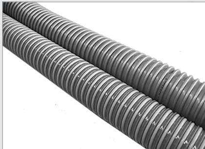
Set tuyau aspiration BSP10: composés chacun de 10 m de tuyau aspirant antistatique DN51 avec tresse de mise à la terre en cuivre et indicateur d'usure (rouge) ; tuyau de retour d'air DN51 (gris); sans collier de serrage; gaine à paroi mince.
