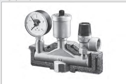
Jeu composé de „Bloc MSM“, groupe de sécurité chaudière et robinet à tournant sphérique Optiflex. Groupe MSM composé de purgeur automatique avec fermeture auto, manomètre avec fermeture auto, isolation et soupape de sécurité à membrane 3,0 bars; avec raccord à filetage intérieur 1. Robinet à tournant sphérique Optiflex pour remplissage et vidange de la chaudière, avec filetage extérieur DN15 1/2" auto-étanche, avec contre-écrou, avec raccord pour tuyau (joint souple) et bouchon.
