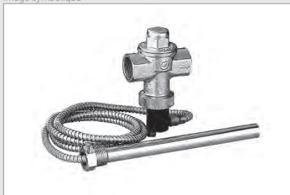
Soupape de sécurité thermique pour la limitation de la température de l'eau des chaudières à combustibles solides avec chauffe-eau ou serpentin de refroidissement intégré, longueur du tube capillaire: 1300 mm, douille plongeante pour sonde 1/2" filetage extérieur, pression de service maxi 10 bars.
