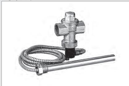
Souape de sécurité thermique pour la limitation de la température de l'eau des chaudières à combustibles solides avec chauffe-eau ou serpentin de refroidissement intégré, longueur du tube capillaire: 1300 mm, douille plongeante pour sonde 1/2" filetage extérieur, pression de service maxi 10 bars.
