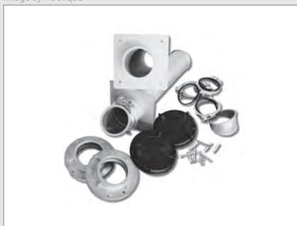
Système de passage mural 45° comportant un raccord de remplissage et d'air de retour; longueur 500 mm; raccord avec couvercle et chaîne; plaque de brides murale 200x200x2 mm avec 4 trous de fixation de D10 mm vissés sur raccord pour montage simple; 2pcs coudes à 45° avec joint d'étanchéité; bord à bride pour possibilité d'extension; matériel de montage (4 vis à double filetage, chevilles multi-usages et vis de carrosserie) dans sachet à fermeture et carton.
