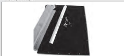
Tapis antichoc 1200x1000 mm avec matériau de fixation pour montage plafond; implantation face aux tubulures d'injection; distance entre tapis antichoc et paroi minimale de 300 mm.
