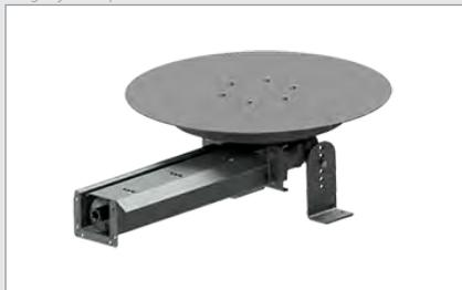
Agitateur avec boîte de vitesses, y compris les lames de ressort et la tête de décharge, et le matériel de fixation. La hauteur maximale de déversement est de 5,0 m pour les copeaux de bois.
