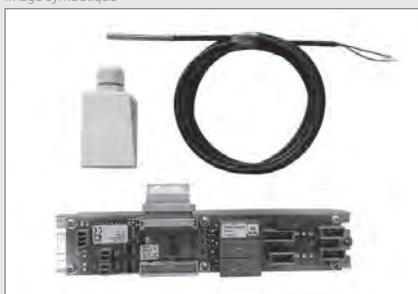
Module d'extension interne 'Eau chaude/circulation 533' avec 3 sorties de relais pour le montage ultérieur dans une chaudière à pellets, y compris sonde de chauffe-eau et sonde d'applique (circulation), set de fiches et de connexion avec câble de mise à la terre pour la commande d'une pompe de chauffe-eau.
