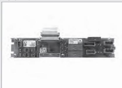
Module d'extension interne '533' avec 3 sorties de relais pour le montage ultérieur dans une chaudière à pellets, y compris kit de fiches et de connexion avec câble de mise à la terre.
