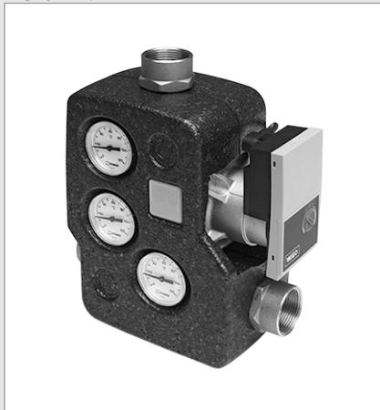
Groupe de élévation température de retour de retour DN32 avec pompe de charge de classe A intégrée, économe en énergie ; puissance absorbée comprise entre 3 et 45 watts (type Wilo Yonos Para) pour chaudière à gazéification de bois HVZ25L et HVZ34L.
