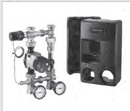
Survoltage du retour DN25 avec pompe à haut rendement Wilo Yonos Para 25/6 RKC (longueur de construction 130 mm), vanne mélangeuse à trois voies intégrée avec régulateur de température pour le survoltage du retour; départ à droite ou à gauche.
