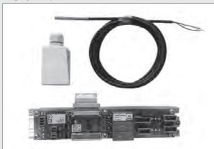
Module d'extension interne 'Eau chaude/circulation 533' avec 3 sorties de relais pour le montage ultérieur dans une chaudière à bois déchiqueté, y compris sonde de chauffe-eau et sonde d'applique (circulation), set de fiches et de connexion avec câble de mise à la terre pour la commande d'une pompe de chauffe-eau.
