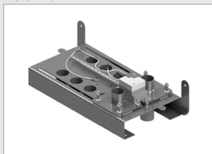
BM3 (BM5) composé d'un support et d'un chariot pour un maximum de 3 (5) raccords de tuyaux (aspiration et retour d'air) des systèmes d'extraction. Le coulisseau est déplacé au moyen d'un moteur à crémaillère de Belimo et interrogé par le système de commande de chaudière Reflex. Conçu pour un montage mural, y compris le module BCL 541 et les vis de fixation.
