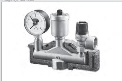
Kit comprenant un „Bloc MSM“ de sécurité de chaudière et un robinet à boisseau sphérique Optiflex Le bloc MSM comprend un purgeur rapide avec vanne d'arrêt automatique, un manomètre avec vanne d'arrêt automatique, une isolation et une vanne de sécurité à membrane 3,0 bar.
