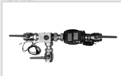
Relevage du débit de retour DN50 avec pompe de relevage du débit de retour à haut rendement UE 55A-32 pour chaudières à bois avec filetage interne de 2". Tous les raccords à joint plat, complètement prémonté avec un régulateur à valeur fixe et un moteur de mélangeur intégré, sans thermomètre (avec tampon ou séparateur hydraulique).
