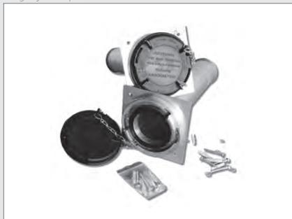
Système de passage mural droit, comportant un raccord de remplissage et d'air de retour; longueur 500 mm; raccord avec couvercle et chaîne; plaque de brides murale 200x200x2 mm avec 4 trous de fixation de D10 mm vissés sur raccord pour montage simple; bord à bride pour possibilité d'extension; matériel de montage (4 vis à double filetage, chevilles multi-usages et vis de carrosserie) dans sachet à fermeture et carton.
