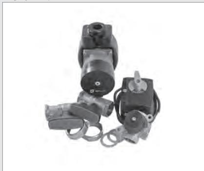
Renforcement du débit de retour DN25, avec pompe à haut rendement Mini PLUS 25-60, longueur totale 180mm, vanne de mélange à trois voies intégrée avec servomoteur pour le renforcement de la température de retour.
