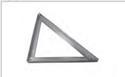
Système de glissement 45° galvanisé et biseauté pour montage facile; pour fondation du fond incliné dans zone de stockage de pellets; composé de 3 profils d'angle; 1 x longueur 650 mm pour montage du fond, 1 x longueur 650 mm pour montage de l'étau et 1 x longueur 920 mm pour montage plaque(s) oblique(s); matériel de montage (2 vis à double filetage 8x60, chevilles multi-usages et vis de carrosserie; 3 vis à six pans 10x20, écrous six pans M10) dans sachet à fermeture; emballé et isolé par film.
