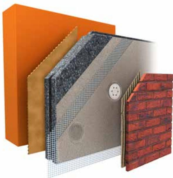
*Le système d'isolation Façabrick permet parfaitement de post-isoler la façade par l'extérieur. Le panneau isolant en polystyrène expansé est déjà revêtu d'une couche de mortier avec treillis d'armature intégré. Assurant ainsi une meilleure adhérence des plaquettes, une pose aisée et une excellente étanchéité à l'eau. Si nécessaire, l'épaisseur totale peut rester limitée à 14 cm.*
