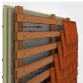
Structure portante en cas d'isolant rigide
