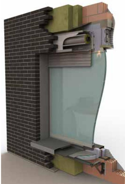
ShutterX® avec appui de fenêtre en pierre bleue, brique
